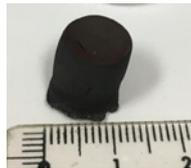
Figura 1. Fotografía de una estructura 3D de RGO/BiOI/PEO.
