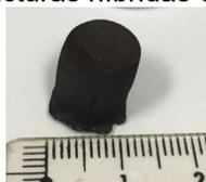
Figura 1. Fotografía de una estructura 3D de RGO/BiOI/PEO.
